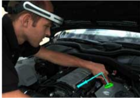
Abb. Xx: Ein Servicetechniker bekommt einen Hinweis über die Drehrichtung eines Verschlusses
