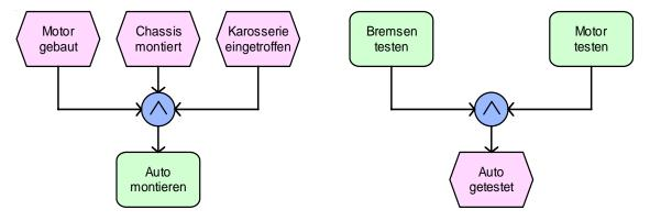
ODER wird umgangssprachlich mit *Entweder ... oder ...* ausgedrückt. Auf ein Ereignis darf allerdings kein exklusives ODER erfolgen, denn dann wäre unklar, welcher der möglichen Pfade gewählt werden sollte. Die Entscheidung, welcher Pfad zu nehmen ist kann nur von einer Funktion getroffen werden. Anders formuliert: Ereignisse treffen keine Entscheidungen.
