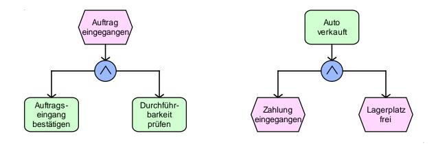
Weiterhin kann der UND-Operator mehrere eingehende Pfade zu einem Pfad verknüpfen. Das ausgehende Ereignis bzw. die ausgehende Funktion beginnt erst dann, wenn **alle** eingehenden Pfade ausgeführt wurden. Ist einer der Pfade nicht vollständig durchlaufen, kommt der Prozess an dieser Stelle solange zum Stillstand, bis auch der letzte Pfad erfüllt ist. Dies gilt wiederum sowohl für eingehende Ereignisse als auch für eingehende Funktionen:
