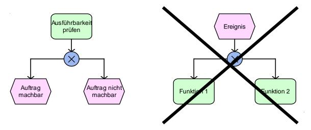
Weiterhin können mit dem exklusiven Oder mehrere eingehende Pfade zu einem Pfad verknüpft werden. Die ausgehende Funktion bzw. das Ereignis beginnt im Gegensatz zum UND-Operator bereits, wenn **einer** der eingehenden Pfade ausgeführt wurde.
