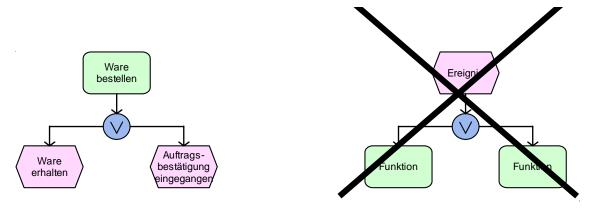
Durch das inklusive Oder können auch mehrere eingehende Pfade zu einem ausgehenden Pfad verknüpft werden. Wie beim exklusiven ODER beginnt die ausgehende Funktion bzw. das Ereignis bereits, wenn **einer** der eingehenden Pfade ausgeführt wurde.
