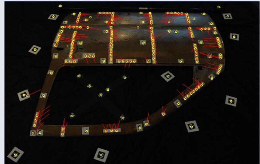
Deformationsvektoren an einer Autotür nach mechanischer Belastung (IAPG)
