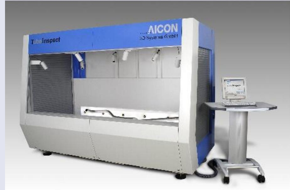
Automatisches Rohrleitungsprüfsystem mit direkter Kopplung an Biegemaschine (AICON)
