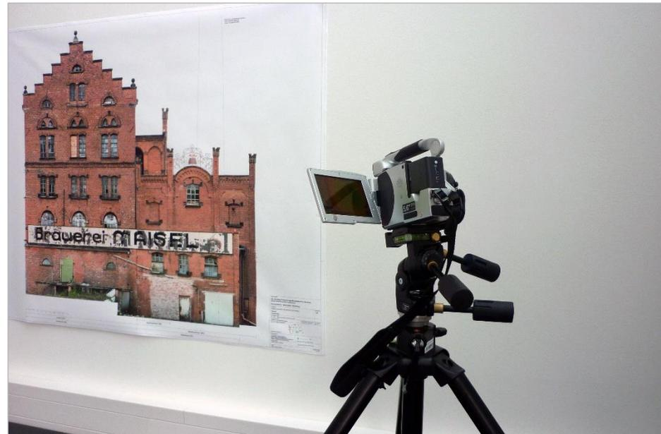
Infrarot-Kamera VarioCAM (LWIR) für den Einsatz in technischer Bauwerksanalyse, Bauforschung und Bauertalt (Luib 2018)
