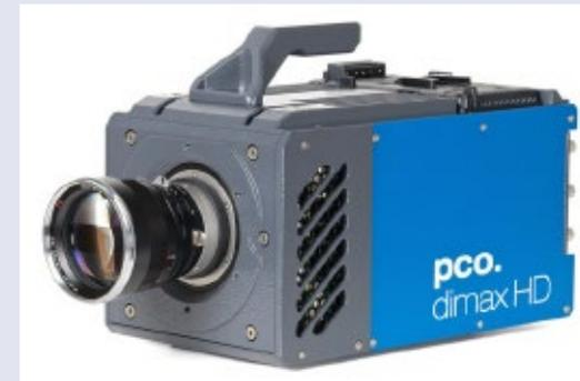
Highspeedkamera 1500 Bilder/sec bei 2000 x 1000 Pixel (PCO)
