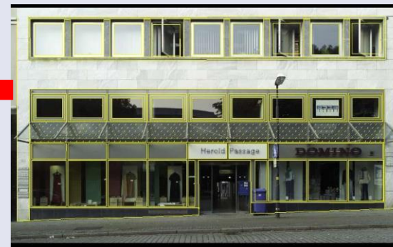
Entzerrung mit überlagerter Zeichnung
