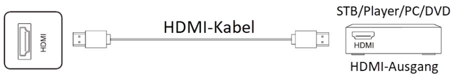
**Hinweis:** Die vom HDMI-Anschluss unterstützte maximale Auflösung beträgt 4K bei 60Hz. Die detaillierten Signalformate finden Sie im Abschnitt Technische Parameter. Wenn 4K-Signale bei 60Hz wiedergegeben werden, sollte die EDID-Version im OSD-Menü auf EDID2.0 umgeschaltet werden.
