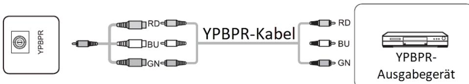
**Hinweis:** Der Typ des YPBPR-Anschlusses ist ein Ø 3,5 mm MINI- Anschluss. Für Signalverbindungen werden ein MINI-Adapterkabel und ein YPBPR-Kabel benötigt. (Legende: RD = Rot, BU = Blau, GN = Grün)
