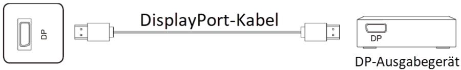
**Hinweis:** Die vom DP-Anschluss unterstützte maximale Auflösung beträgt 4K@60HZ. Die Signalqualität hängt von der Länge und Qualität des DP-Kabels ab. Verwenden Sie daher die empfohlenen Kabel oder die Kabel bekannter Marken.
